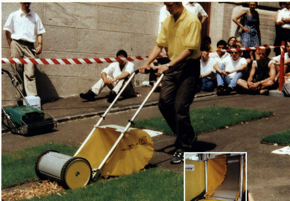
Die Messertrommel dieses Handrasenmähers lässt sich mit einer Bürste tauschen
