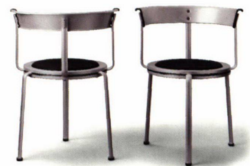
30 | 1989 | Für die Möbeledition <Sele 2> entwickelter Innen- und Aussenstuhl in Aluminium mit Sitzpolster aus Integralschaum. Der Sitz aus zwei identisch gedrückten Blechtellern funktioniert als Klemmkonstruktion für die drei Beine und die Rückenstütze
