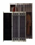
38 | 1998 | Balgenschrank, Mod. Nr. 480. Konstruktion nach dem Prinzip einer Balgen-Fachkamera. Front- und Rückenrahmen aus Alu-Profilen mit dazwischen montiertem, plissiertem Balgentunnel aus Polyurethan. Je nach gewünschter Tablartiefe ausfahrbar bis 60 cm. Verschluss durch Faltvorhang analog Mod. Nr. 440
