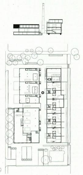
Querschnitt zwischen den beiden Gewerbebauten. Die Geschosshöhen erlaubten Maisonettewohnungen im Erdgeschoss. Die Dachwohnungen sind aufgesetzte Leichtbauten
