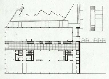
Grundriss Erdgeschoss: Eine prächtige Halle erhebt sich über die ganze Höhe des Gebäudes, in der Gebäudemitte verbindet ein System von Stegen, Brücken und kaskadenartigen Treppen alle Abteilungen miteinander
