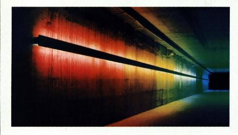
«Meter by meter» von Matteo Thun für Belux. Das Lichtsystem kann sozusagen per Meter als Wand-, Ecken-, Deckenoder Rahmenleuchte und als transparente, indirekte Beleuchtung oder Beschriftung eingesetzt werden.
