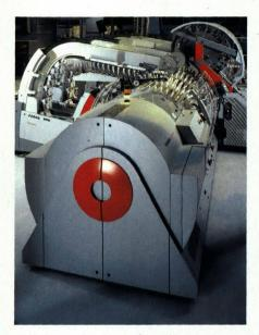
«Combi Drum» und «Combi Server» von Meyer-Hayoz Design Engineering Winterthur für Ferag. «Combi Drum» sammelt, heftet und klebt Druckprodukte. Der «Combi Server» ruft die Produkte einzeln ab und speist sie in den «Combi Drum» ein. Der ergonomisch gestaltete Arbeitsplatz steht im Mittelpunkt des Designkonzepts.
