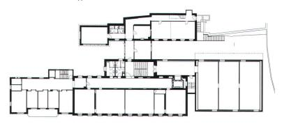
Grundriss Eingang. Die Bodenhöhe ist ein Lauf tiefer als das bestehende Erdgeschoss
