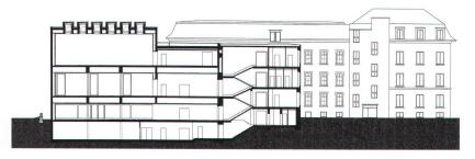
Grundriss Oberlichtsaal. Die Bodenhöhe korrespondiert mit dem 3. Geschoss des Altbaus
