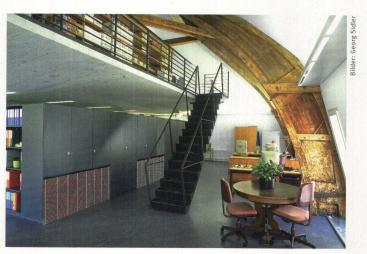
Büros auf dem ehemaligen Heuboden, gut sichtbar die alten Brettschichtträger. Die Galerie aus Beton dient als Lager und Raum für die Haustechnikzentrale
