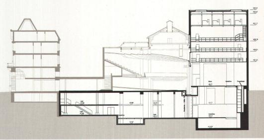
Querschnitt mit schwarz eingetragenen umbauten. Der Bühnenturm wird etwas höher, die Raumhöhe im κeller grösser. Das erlaubt einen effizienteren Betrieb. Die κellerbühne zieht in den schiffbau um
