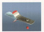
Umklappen: Den in sich geschlossenen Teil aufreissen – das teilt die Packung in eine obere und untere Hälfte. Die wird über die Bewegung des Parallelogramms deckungsgleich über eine Öffnung umgeklappt. So kommt die Pille dank eines leichten Drucks frei
