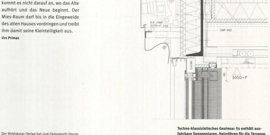
fahrbare Sonnenstoren, Heizröhren für die Terrasse, Anti-Insekten- und Fluoreszenzlampen. Unten die Schiebetüre, die mit einer Bürste direkt an die Glas-
