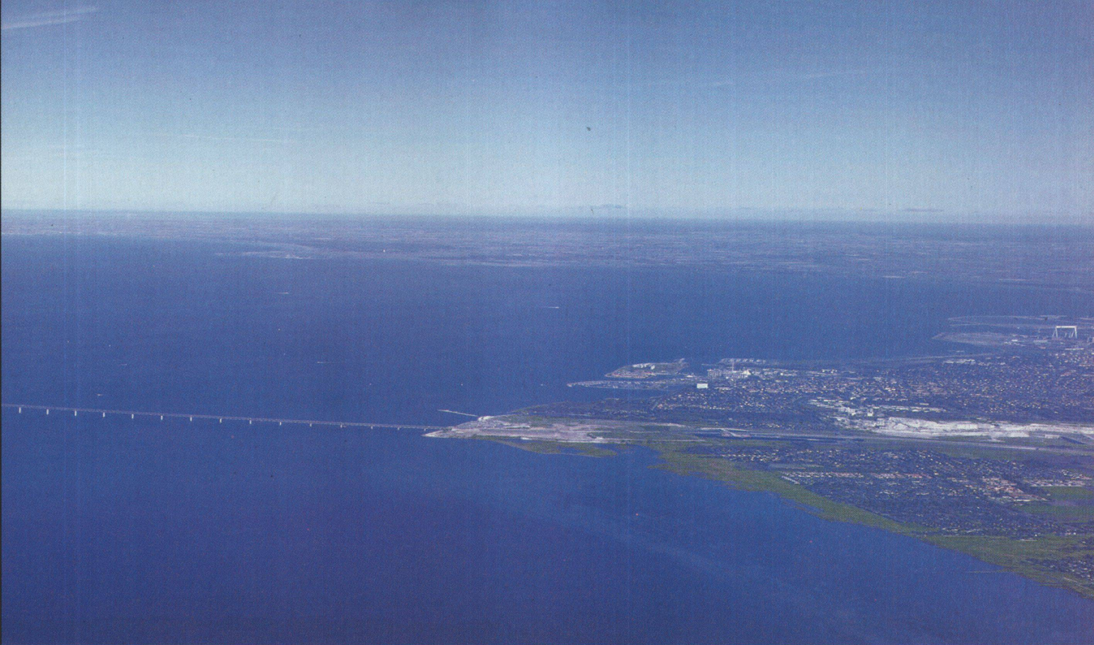
Die Brücke über den Öresund: links die künstliche Insel mit dem Portal zum Unterwassertunnel: Die östliche Zufahrtsbrücke ist 3000 m lang, die westliche 3700 m. Die Spannweiten zwischen den insgesamt 51 Pfeilern betragen 120 bis 140 m. Die Hauptbrücke, eine 1100 m lange Schrägkabelbrücke, hat eine Spannweite zwischen den Pylonen von 490 m. Die Fahrbahn quert 57 m über dem Meeresspiegel die Schiffahrtsrinne. Die Pylonen sind 204 m hoch
