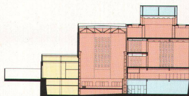
Querschnitt C-C: Das Restaurant auf der Ebene 2 hat Anschluss an den Uferpark. Darüber ein doppelt hoher Saal mit einer Beuys-Installation
