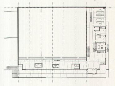
Oben: Grundriss Eintrittsgeschoss. Links das Spielfeld, rechts der Vertikalschlitz, unten der Eingangsbereich mit den WC-Boxen Unten: Schnitt durch die Spielhalle. Gut erkennbar die Oblichter und die Stahlkonstruktion für die Hülle. Links unten der Werkhof
