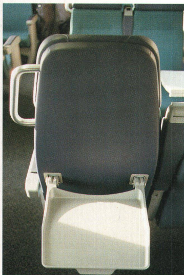
Mehr braucht ein guter Klapptisch im Zug nicht: Fläche, Rand und Stabilität. Das alles haben die Designer in einem einzigen Teil untergebracht. Und formschön ist es auch noch
