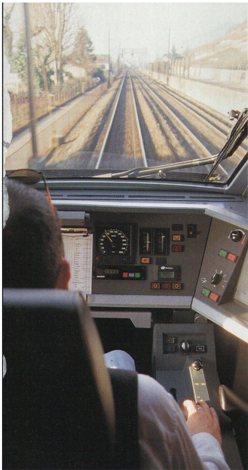
Der Lokführer sitzt in der Mitte der Zugspitze. Der Arbeitsplatz entspricht im Wesentlichen dem der Lok 2000
