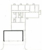
Grundriss Eingangsgeschoss. Bestehende Garage, darüber Eingangshalle mit den drei gleichwertigen Wohnungseingängen. Im hinteren Teil die Kellerräume
