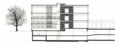
Schnitt des Annexbaus. Die Architekten haben den Bau aufgestockt, die Treppen, Licht- und Lüftungsschächte zu Service-Türmen gefasst
