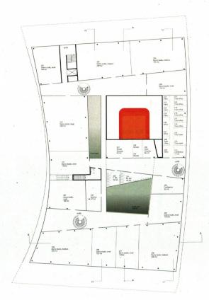
Grundriss Obergeschoss (links) und Nutzungsschema (unten). Die beiden Höfe sorgen für Querblicke und Tageslicht
