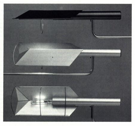
Schwarz oder farblos eloxiertes Aluminiumblech wird – wie Papier zum Papierflugzeug gefaltet – zum Reflektor gebogen. Der schmale Schlitz auf der oberen Kante genügt, um die Hitze abzuführen
