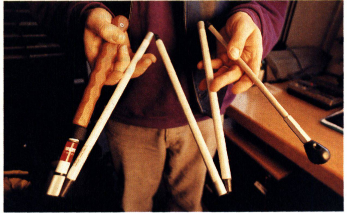
Der Stock hat gesamthaft sechs Rohrteile aus eloxiertem Aluminium, die Verbindung zwischen den unteren fünf Teilen bilden konische Abschlüsse. Das Ende des Stockes bildet der birnenförmige Tastkörper aus Spezial-Polyäthylen
