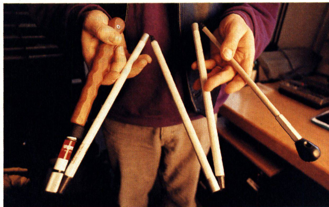
Der Stock hat gesamthaft sechs Rohrteile aus eloxiertem Aluminium, die Verbindung zwischen den unteren fünf Teilen bilden konische Abschlüsse. Das Ende des Stocks bildet der birnenförmige Tastkörper aus Spezial-Polyäthylen
