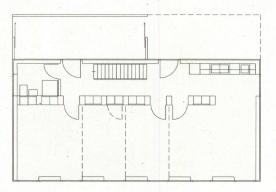
Grundriss Erdgeschoss. Der Küchen-, Bad- und Erschliessungsteil ist durch eine Schrankwand vom Wohnteil getrennt. Dieser kann je nach Wunsch bis in vier Zimmer unterteilt
