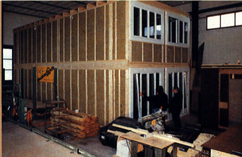
Die 0-Nummer als Kontrolleinheit bevor die 48 Wohnungseinheiten der Siedlung Espenwald in Produktion gingen
