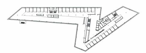
Grundriss Obergeschoss Aus dem dreieckigen Erdgeschoss wurden zwei Spickel herausgeschnitten, was den blitzförmigen Grundriss in den Obergeschossen ergibt
