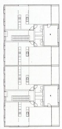
Ein kleines Schaltzimmer (1) ist in die Mitte des Hauses eingeschoben. Mit Schiebewänden lässt sich die weite Ein-Raum-Wohnung in drei Bereiche unterteilen
