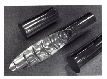
Das Bauprinzip: Ineinander geschobene und verklebte Alubüchsen; der Boden hilft stabilisieren, die minimale Überlappung zweier Büchsen beträgt 8 mm, je grösser sie wird, umso stabiler, aber auch umso schwerer wird die Stange
