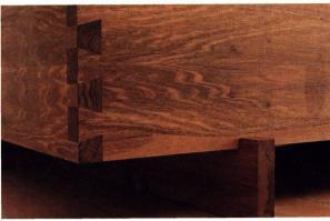
gehölzer gesteckt, die Ecken sind mit einer Schwalbenschwanzzinkung verleimt. Das Bett ist auch ohne Metallverbindungen stabil und zerlegbar
