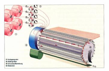
Funktionsschema. Die Fäden kommen von links von vier Spulen und werden in einer kontinuierlichen Bewegung in den Schuss-kanal geblasen
