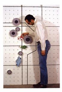
Die Bedienbarkeit der Maschine wird an der Steckwand von verschieden grossen Leuten getestet
