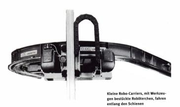
roboloop® ist ein patentiertes kurvengängiges Portal-, Transfer- und Hängebahnsystem. Es erlaubt neue, kreisförmig angeordnete Konzepte in der Automations- und Handhabungstechnik. Modernste Bustechnologie ermöglicht das Ansteuern und Verwalten von mehreren Laufwagen in einem gemeinsamen Umlaufsystem. Präzisions-Führungssystem und formschlüssiger Antrieb. Integrierte Zusatzperipherie wie Weichen, Kreuzungen, Liftstationen; Zubehör für Carrier (Vertikalachsen, Drehachsen, Plattformen).
