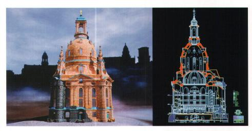
Links: Die Simulation der Frauenkirche in Dresden (Bild: IBM) Rechts: Schnitt des 3D-Basismodells, aus dem sich alle andern Pläne herausziehen lassen (Bild: IPRO Dresden)
