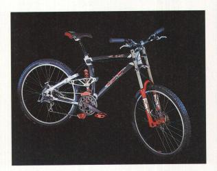
Spezialistentum, Hightech und Komfort bestimmen heute die Technik und das Design von Mountainbikes. Eines der jüngsten Beispiele ist das Velo der US-Marke GT: Der Rahmen besteht aus Thermoplast, die Federung ist auf extreme Talfahrten eingerichtet, die Achsaufhängungen werden computergesteuert gefräst und gebremst wird via Scheiben
