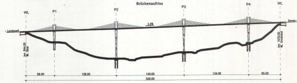
Aufriss der Brücke: Die Gesamtlänge misst 526 m, die Spannweite 140 m. Beide Brückenenden sind fest mit den Widerlagern und die vier Rahmenpfeiler fest mit der Fahrbahn verbunden: So wird die beste aller Brückenlagerungen möglich
