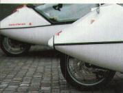
Die Karosserie ist in Längsrichtung zweigeteilt. Der vordere Abschluss ist eine etwas übertriebene Hommage an Windschlüpfrigkeit
