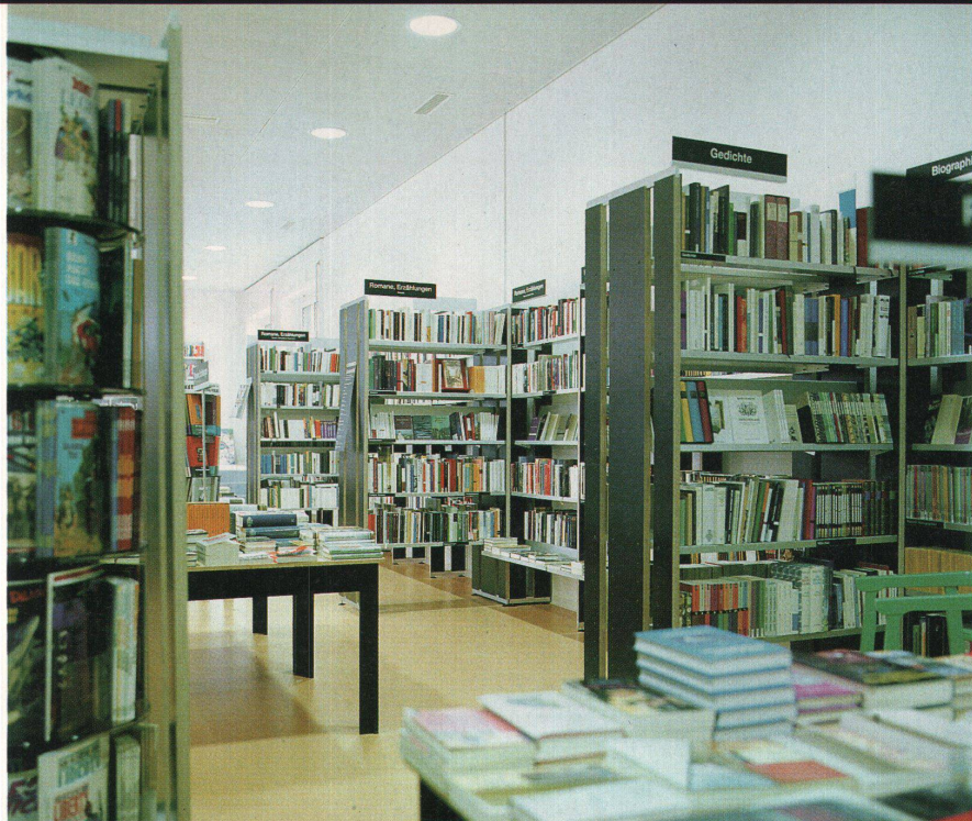
Gestelle aus Birken-Multiplex, oben fixiert mit einem Aluprofil
