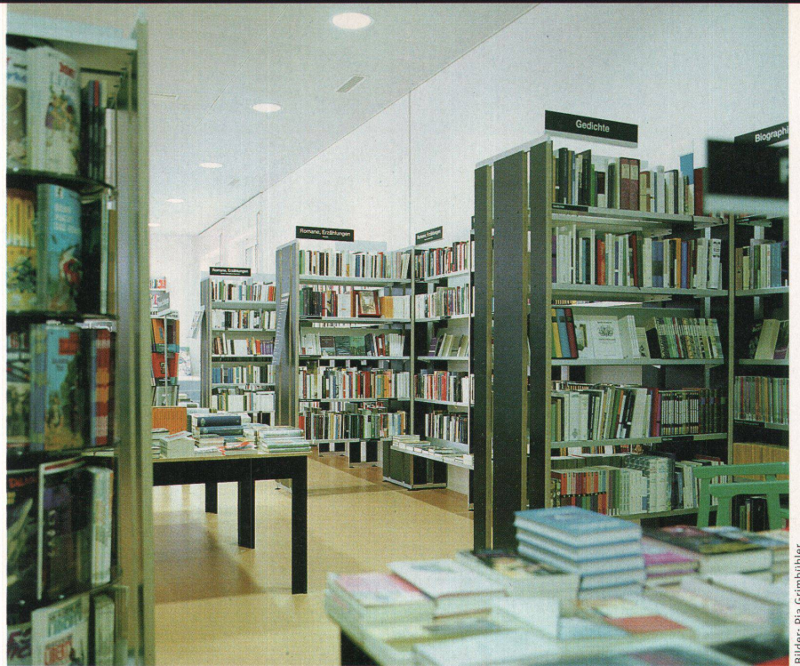
Gestelle aus Birken-Multiplex, oben fixiert mit einem Aluprofil
