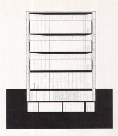
Querschnitt A-A. Die Betonwanne ist von einem Gerüst mit einer äusseren und inneren Glasschicht umhüllt.
