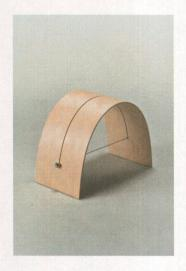
Birkensperrholz, Draht und zwei Chromstahlkugeln - fertig ist der Hocker von Kai Holpert aus Deutschland. Das leichte Möbel besteht aus vier Schichten gebogenen Birkensperrholzes. Da der Draht, der in den Schlitz gepannt wird, kürzer ist als der Abstand zwischen den Holzenden, zieht dieser sie zusammen. Der Hocker (Bow Stool) erhielt den Selection Committee Chairman's
