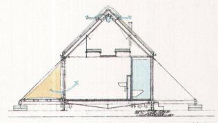
Das Projekt Zampano's V... schlägt als einziges der sechs keine Kiste, sondern eine Plattenkonstruktion vor. Der Zeltquerschnitt ermöglicht Betten in Hochlage. Die Module werden zu verschiedenartigen (Feriendörfern) zusammengestellt. Kosten pro Modul Fr. 47 640.–
