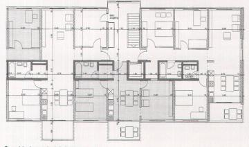
Grundrissbaustein A.D.P./Steiner. Bei einer Bautliefe von rund 12 Metern wird ein Ost-West-Typ auch für die Nord-Süd-Lage eingesetzt, was das Preisgericht trotz Kostenvorteilen ablehnte
