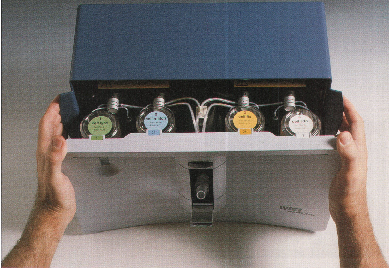
Zellpräpariersystem für Analysen mit Durchflussszytometer Lyset, für Hamilton, 1994. Die Blutprobe kommt in die Kipphalterung in der Mitte. Mit einfachem Handgriff lassen sich die vier Reservoir-Flaschen für Reagenzien einsetzen. Eine Serie von gefahrgeschützten Nadeln sorgt für Perforation zwecks Luftzufuhr, sobald der Deckel zugezogen wird
