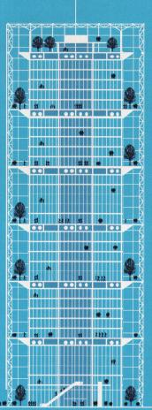
Der Stadtturm besteht aus sechs vertikal geschichteten Blockrandbauten, eingefasst von einer Glashaut
