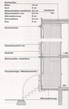
behandelt (Karbonatisierungsbremse). Die Betonelemente (Lifttürme ausgenommen) erhielten einen 4 cm starken, zusätzlichen Wärmedämmputz, und die Fugen wurden neu ausgebildet. Alle Fenster der Eingangsfassade wurden durch Holz-Metallfenster ersetzt und die Hauseingänge mit einem zusätzlichen Windfang versehen.
