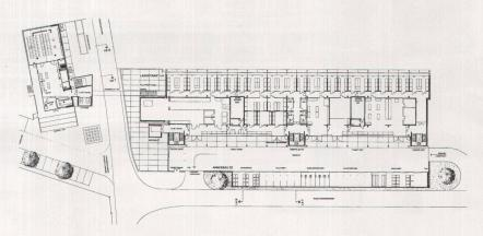
Grundriss Erdgeschoss. Vor dem Labortrakt steht der eingeschossige Annexbau für Lager und Fahrzeuge
