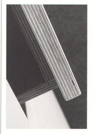
«Um edles Holz möglichst effizient einzusetzen brauchen wir bei uns das aus minderwertigen Materialien hergestellte Sperrholz und veredeln es mit Furnieren aus Ahorn.»
