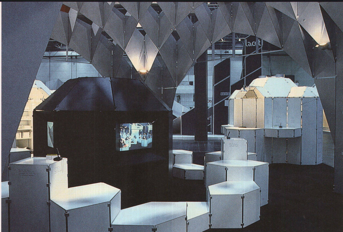
Über zwanzig Jahre alt: Voluma von Ruedi Zwissler, ein Standbausystem aus Platten und Verbindungsstücken
