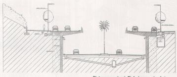
Platzsparen durch Tieferlegung der Autobahn und den Zubringern auf den flankierenden Stützmauern
