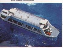
frischen Seeluft. 600 Passagiere sowie 50 Autos soll das 60-Meter-Schiff fassen. Zwei Voith-Schneider-Propeller treiben es mit 22 km/h an.
