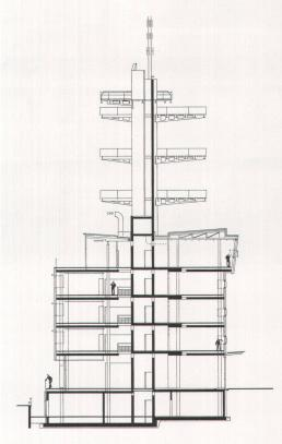
Längsschnitt: Die Betonscheibe ist Antennenturm und Erschliessungsachse zugleich
