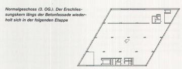
Normalgeschoss (3, OG.), Die parallel zu den geschlossenen Betonfassaden angeordneten Stützscheiben erlauben eine freie Raumaufteilung
