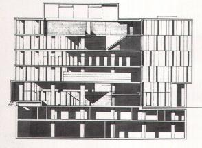
Das Fenster gegen die Autobahn. Aus Lärmschutzgründen ist die Fassade zweischichtig. Innere, äussere Haut und, Lüftungsflügel überlappen sich. Das ergibt ein spannendes Wechselspiel
