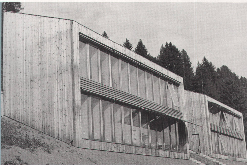
Die südgerichtete Fensterfront lässt die zum Heizen nötige Energie hindurch
