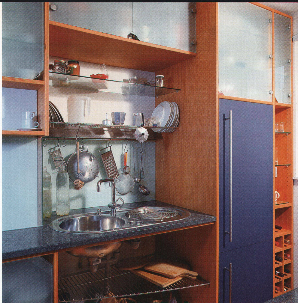
«Schottenbauweise» aus Buchenplatten nennt der Architekt Georg Horka die Konstruktion seines prämierten Küchenumbaus
