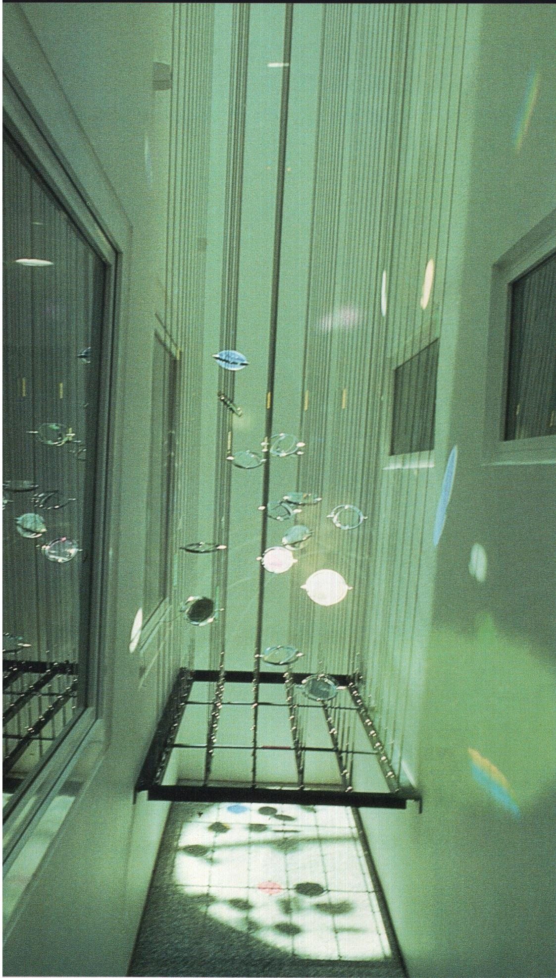
Die raffiniertesten Beleuchtungssysteme ändern nichts daran, dass Augen und Gemüt das natürliche Licht brauchen. Deshalb ist Tageslichtnutzung für fensterarme Bauten wichtig. Mit Heliostaten wird versucht, das Tageslicht in tiefe Korridore und dunkle Untergeschosse zu locken.
