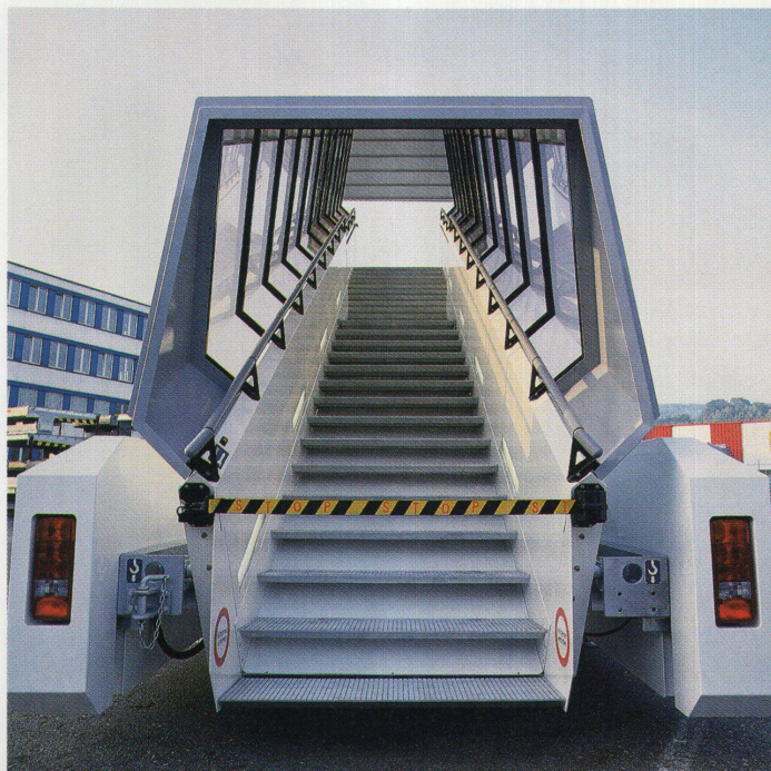
Detailarbeit II: Markant gestaltete Handläufe im Treppentunnel
